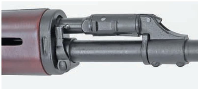
*Регулятор газового двигателя обеспечивает надёжную работу автоматики в неблагоприятных условиях и с различными патронами*
